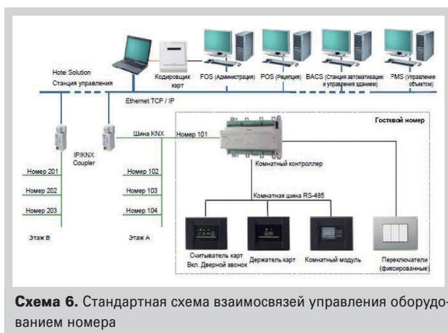
**Схема 6.** Стандартная схема взаимосвязей управления оборудованием номера
