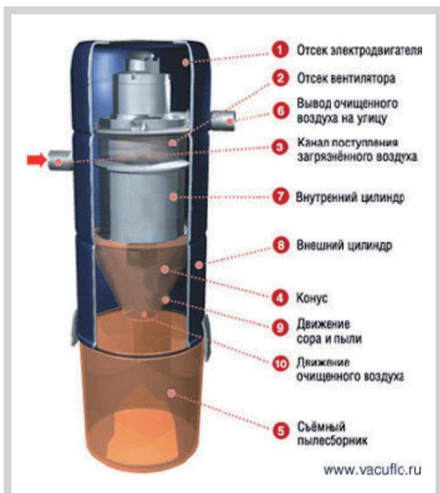
**Рисунок 2.** Установка централизованного пылеудаления
